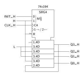
Figura 15.21: Contador em anel que utiliza um registo de deslocamento universal
