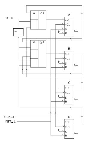
Figura 16.35: Continuação da construção do logig<br/>rama anterior, com as excitações no estado  ${\cal B}$
