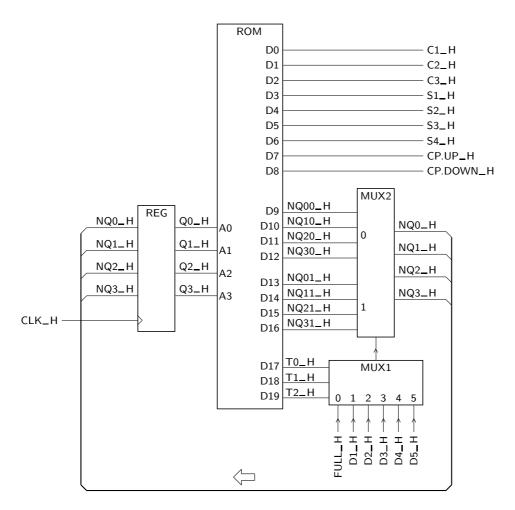
Figura 19.19: Diagrama de blocos da máquina de estados das Figuras 19.17 e 19.18, com controlo por ROM com endereçamento explícito
