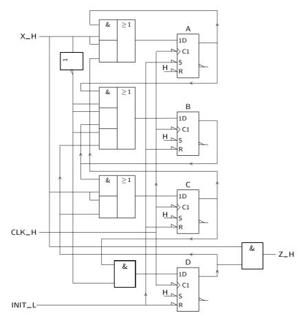
Figura 16.36: Logigrama final do detector da sequências de Mealy da Figura 16.32, implementado com um flip-flop por estado
