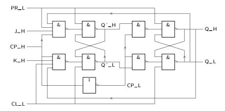
Figura 13.6: Logigrama de um flip-flop JK master-slave com entradas assíncronas de Preset e de Clear activas a L e que comuta nos flancos descendentes dos impulsos de relógio
