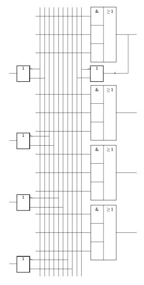
Figura 18.12: Estrutura de uma PAL com n=4 entradas, p=12 ANDs programáveis, e q=4 saídas
