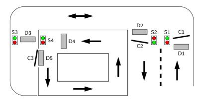
Figura 19.2: O controlo do acesso ao parque de estacionamento deverá abrir ou fechar as cancelas de acesso C1 a C3— consoante os valores lidos nos sensores D1 a D5— e controlar os semáforos S1 a S4, para além de gerar os sinais de comando (no caso, dois sinais de relógio) necessários ao funcionamento do circuito controlado, recolhendo deste o sinal de estado que indica quando o parque está cheio
