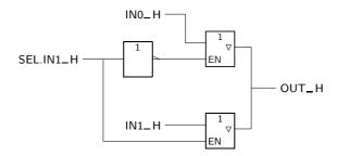
Figura 15.17: Multiplexagem temporal de dois dados, obtida à custa de dois Buffers tri-state
