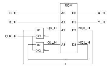
Figura 19.10: Diagrama de blocos com a estrutura básica de controlo por ROM para a máquina de estados da Figura 19.9
