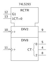
Figura 14.9: Símbolo do contador assíncrono 74LS293, de acordo com a norma IEC
