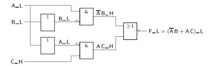
Figura 7.22: Alteração do logigrama anterior, que não altera a função
