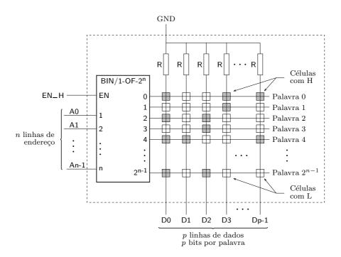
Figura 17.2: Modelo matricial de uma ROM com n linhas de endereço e p linhas de dados, ou ROM de  $2^n \times p$ . Esta ROM possui  $2^n \times p$  células, umas programadas com níveis H (a cinzento), outras a L (a branco)
