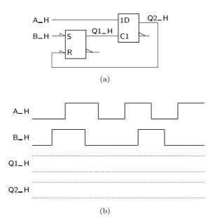
Figura 12.24: (a) Circuito do Exercício 12.17; e (b) diagrama temporal a completar
