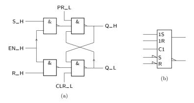
Figura 12.13: (a) Latch SR controlado ao qual se acrescentaram entradas assíncronas de Preset e de Clear activas a L; (b) Símbolo IEC do latch
