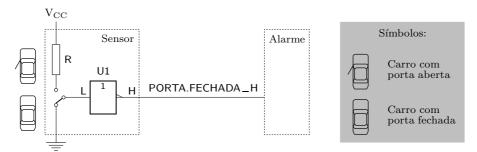
Figura 7.15: O mesmo sensor de alarme da figura anterior: quando a porta do condutor está fechada, na linha de saída do sensor aparece um nível H
