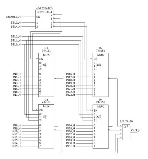
Figura 10.9: Esquema eléctrico de um multiplexer de 32 entradas, realizado à custa de multiplexers de 4 entradas, de um descodificador auxiliar e de uma porta OR
