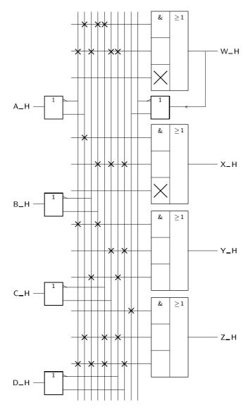
Figura 18.13: A PAL da Figura 18.12 é aqui utilizada para programar a função booleana geral  $\left(18.1\right)$
