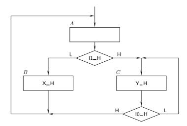
Figura 19.14: A máquina de estados de Mealy da Figura 19.9 tem de ser transformada numa máquina de Moore para se poder utilizar um controlo por ROM com endereçamento explícito. Neste caso, admitiu-se que a saída X podia vir activada no estado B
