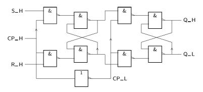
Figura 13.2: Logigrama de um flip-flop SR master-slave que comuta nos flancos descendentes, em que se mostram todas as portas lógicas envolvidas
