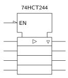
Figura 15.16: Símbolo IEC de um Buffer tri-state quádruplo do tipo 74HCT244
