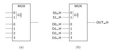
Figura 10.2: (a) Símbolo de um multiplexer com 4 entradas de dados, com entradas e saída activas a H, de acordo com a norma IEC 60617-12; (b) o mesmo multiplexer, ao qual se juntaram variáveis de selecção S0 e S1, de dados D0 a D3, e uma função de saída OUT
