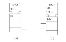
Figura 15.8: Símbolos IEC de registos do tipo: (a) SISO; e (b) PISO
