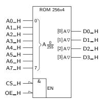
Figura 17.5: Símbolo IEC simplificado de uma ROM típica de 256  $\times$  4, com saídas "tri-state" e duas entradas de controlo activas a L
