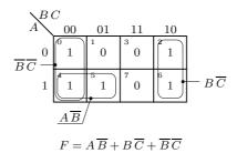
Figura 5.5: Quadro de Karnaugh da função  $F=\sum m(0,2,4,5,6)$ , com os agrupamentos de unidades que dão uma expressão simplificada,  $F=A\overline{B}+B\overline{C}+B\overline{C}$
