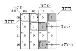
Figura 5.13: (a) Quadro de Karnaugh de uma função que possui implicantes primos essenciais (devido aos quadrados assinalados a cinzento) e não essenciais
