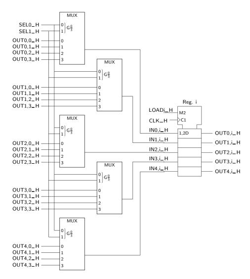
Figura 15.14: A interligação dos 4 registos da Figura 15.14 pode ser feita com multiplexers, mas a solução é muito complexa. Nesta figura apenas se apresenta a ligação a um dos registos
