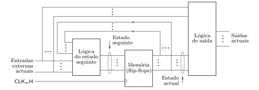
Figura 16.4: Modelo de um circuito sequencial síncrono genérico, onde se pode observar um conjunto de flip-flops sincronizados pelos mesmos flancos de comutação, uma lógica do estado seguinte e uma lógica de saída. As saídas dos flip-flops definem, em cada instante, o estado actual do circuito sequencial. As entradas dos flip-flops definem, directa ou indirectamente, o estado seguinte do circuito
