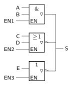
Figura 6.10: As saídas tri-state podem vir interligadas desde que se garanta, por intermédio dos níveis de tensão aplicados às diversas entradas de Enable, que uma e apenas uma saída de cada vez não está em alta impedância
