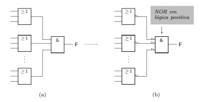
Figura 7.13: (a) Logigrama (e esquema eléctrico simplificado) de uma função em forma conjuntiva (produto de somas); (b) logigrama equivalente e correcto do ponto de vista lógico, que reflecte o facto de estarmos a lidar com um produto de somas, embora implementado com NORs em lógica positiva
