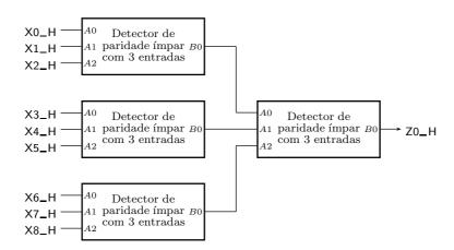
Figura 8.5: Diagrama de blocos de um detector de paridade ímpar com 9 entradas, construído com 3 detectores de paridade ímpar com 3 entradas cada um  $^{\circ}$
