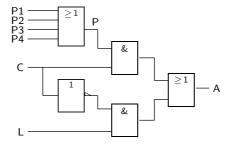
Figura 6.1: Logigrama do alarme  $A = CP + \overline{C}L$
