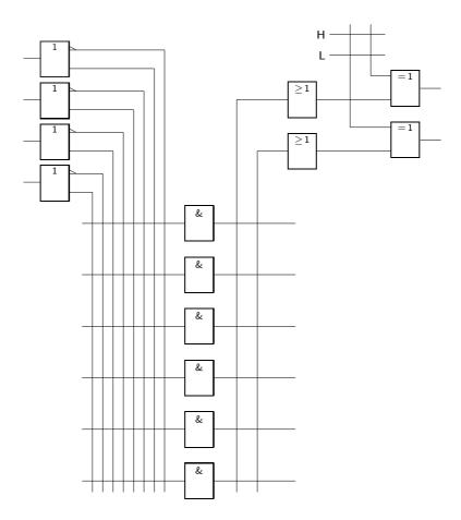
Figura 18.5: Estrutura de uma PLA com n=4 entradas de dados, p=6 ANDs, e q=2 ORs. Este dispositivo permite implementar duas funções booleanas simples de 4 variáveis que possuam expressões booleanas em forma de somas de produtos limitadas a um máximo de 6 implicantes
