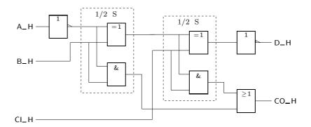
Figura 11.6: Logigrama de um subtractor completo formado por dois semi-somadores e lógica adicional
