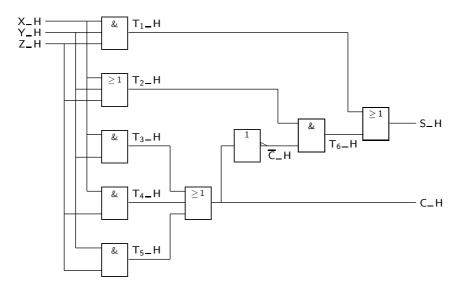
Figura 8.3: Logigrama de outro circuito combinatório onde se identificam as saídas  $T_1$  a  $T_6$  das portas lógicas que interessa analisar para a obtenção da tabela de verdade física do circuito
