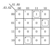
Figura 5.15: Quadro de Karnaugh de uma função booleana simples que detecta dígitos BCD são múltiplos de 3; admite-se que se colocam "0" s nos quadrados 10 a 15, que correspondem a valores nas entradas que não são dígitos BCD
