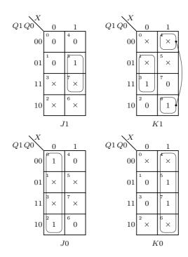
Figura 16.25: Quadros de Karnaugh para as excitações dos flip-flops JK e para a saída do detector de sequências de Mealy da Figura 16.22
