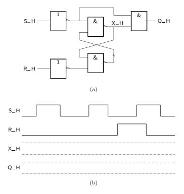
Figura 12.23: (a) Logigrama do latch SR modificado do Exercício 12.16; e (b) diagrama temporal a completar
