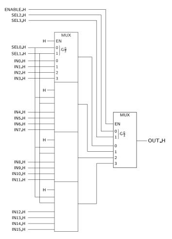
Figura 10.8: Logigrama de um multiplexer com 16 entradas de dados, realizado à custa de multiplexers com 4 entradas de dados, numa estrutura em árvore
