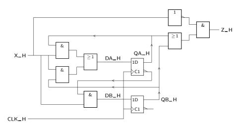
Figura 16.3: Exemplo de circuito sequencial síncrono
