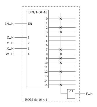
Figura 18.2: Uma forma de representar graficamente a ROM da Figura 18.1 considera a (única) saída como sendo a saída de um OR fictício com 16 entradas, umas programadas com o nível H (aquelas onde se incluiu uma cruz), e outras programadas com o nível L (onde não se colocou uma cruz)
