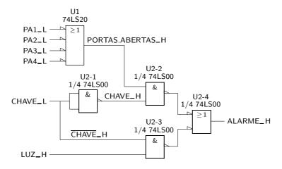
Figura 7.29: Esquema eléctrico do alarme do carro
