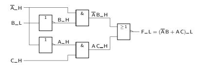
Figura 7.23: Esquema eléctrico para implementação da função dada
