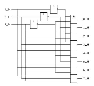
Figura 9.2: Estrutura interna do descodificador binário da Figura 9.1
