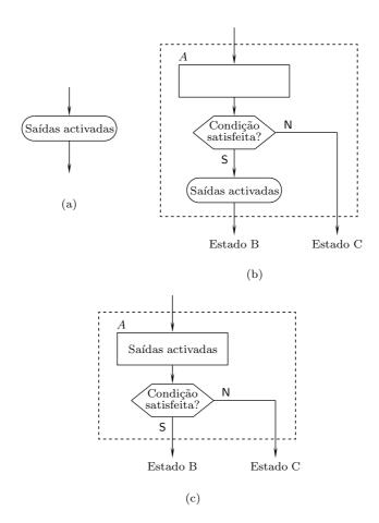
Figura 16.40: (a) Símbolo de uma saída de Mealy. Contraste entre uma saída de Mealy (b) e uma saída de Moore (c) num fluxograma. Enquanto a primeira identifica, no interior do seu símbolo, a saída ou saídas que vêm activadas num determinado estado, A por exemplo, quando uma determinada condição vem satisfeita na entrada ou entradas testadas, a segunda, porque não depende das entradas, vê a saída ou saídas activadas no símbolo do próprio estado
