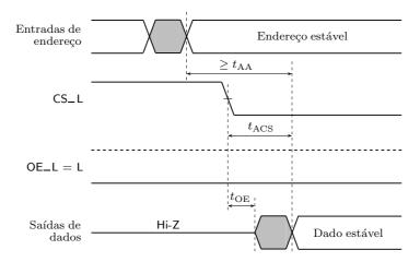
Figura 17.7: Outra parte das temporizações na operação de leitura de uma palavra de uma ROM típica
