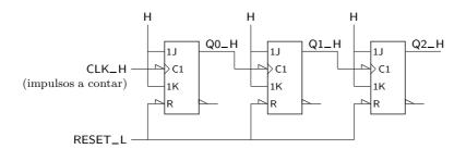
Figura 14.4: Contador asssíncrono módulo 8 que conta segundo o CBN, com entrada assíncrona de Reset
