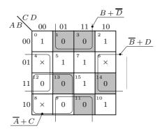
Figura 5.21: Minimização da função  $F=\prod M(1,3,9,11,12,13,14)\cdot \cdot \prod M_d(4,6,8)$
