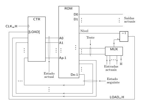
Figura 19.21: Diagrama de blocos de uma máquina de estados com controlo por ROM com endereçamento implícito
