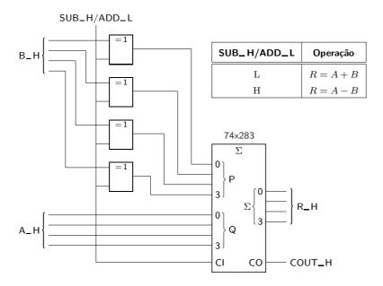
Figura 11.7: Logigrama de um somador/subtractor em complemento para 2
