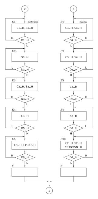
Figura 19.24: Continuação do fluxograma da Figura 19.23
