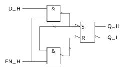
Figura 12.15: Logigrama alternativo para um latch D controlado
