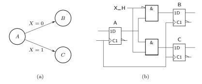
Figura 16.28: (a) Uma transição do estado A para um dos estados B ou C condicionada aos valores lógicos numa entrada, X, tem por correspondência (b) um troço do logigrama (com um flip-flop por estado) que se traduz pela ligação do flip-flop A aos flip-flops B ou C consoante o valor lógico aplicado a X
