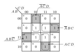
Figura 5.12: (a) Quadro de Karnaugh da função booleana simples  $F=\sum m(1,5,6,7,11,12,13,15)$  que assinala os implicantes primos da função por intermédio dos quadrados assinalados a cinzento
