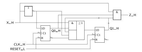
Figura 16.24: Logigrama do detector de sequências de Mealy que utiliza flip-flops  $\mathcal D$
