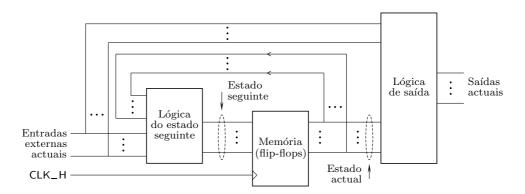
Figura 16.6: Modelo de Mealy um circuito sequencial síncrono
