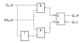
Figura 12.14: Logigrama de um latch D controlado
