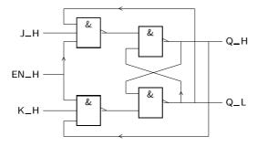
Figura 12.21: Latch JK controlado, obtido por modificação de um latch SR controlado
