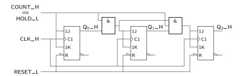
Figura 14.15: Contador síncrono binário de módulo 8, com entrada de Reset assíncrona e entrada síncrona de Enable (Modo), COUNT\_H ou HOLD\_L
