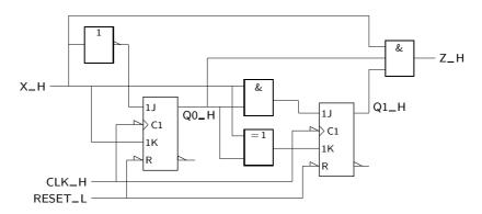
Figura 16.26: Logigrama do detector de sequências de Mealy que utiliza flip-flops  ${\rm JK}$
