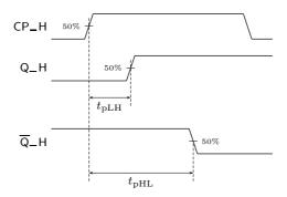
Figura 13.12: Tempos de propagação de um flip-flop
