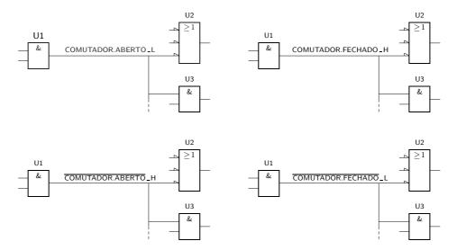
Figura 7.16: Quatro exemplos do *mesmo circuito*, com designações e níveis de actividade variados, porém totalmente equivalentes, para as funções booleanas simples geradas pela porta AND da esquerda. Como podemos constatar, os níveis de actividade das funções não estão correlacionados com o nível de actividade da saída da porta geradora da função nem com os níveis de actividade das entradas das portas à qual a função vem aplicada
