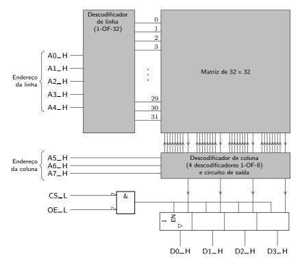
Figura 17.4: Uma ROM de  $256\times4$  vem, na prática, organizada como uma matriz de  $32\times32$ , com um descodificador de coluna e um descodificador de linha, para além do circuito de saída controlado por duas linhas,  $CS\_L$  e  $OE\_L$
