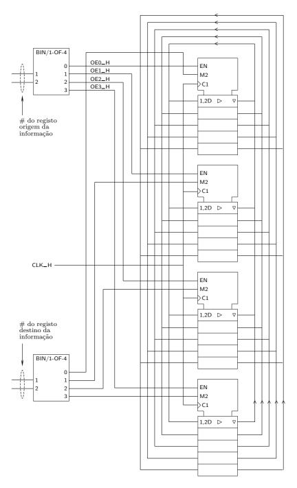
Figura 15.20: Logigrama de um sistema formado por 4 registos interligados com saídas tri-state
