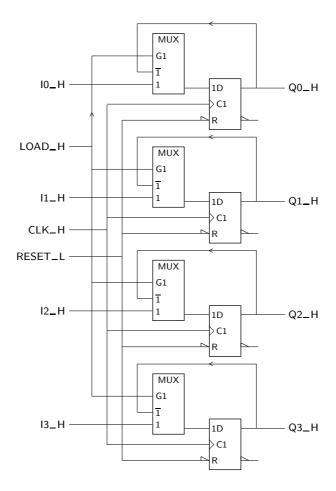
Figura 15.4: Registo de 4 andares com Reset assíncrono e uma entrada de Modo,  $LOAD_-H$ , que permite o carregamento em paralelo síncrono se estiver activada, ou a manutenção do valor carregado quando inactiva
