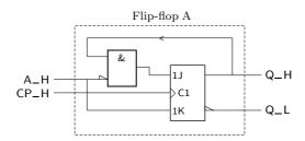
Figura 13.14: Flip-flop hipotético, do tipo edge-triggered, com a designação de flip-flop  ${\bf A}$
