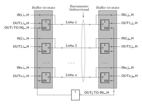
Figura 15.18: Barramento bidireccional com n linhas, controlado por Buffers tri-state unidireccionais
