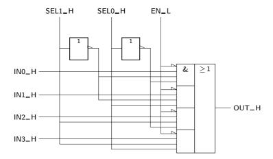
Figura 10.5: Logigrama com a estrutura interna do multiplexer da Figura 10.4
