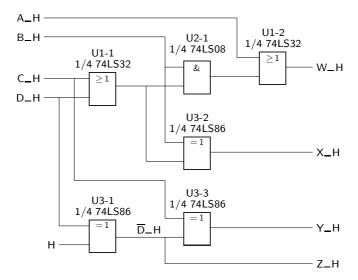
Figura 8.11: Esquema eléctrico do conversor BCD  $\rightarrow D+3$
