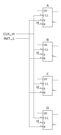
Figura 16.33: Construção do logigrama do detector da sequências de Mealy da Figura 16.32, usando um flip-flop por estado. Nesta fase, apenas se incluem os flip-flops e a inicialização do circuito
