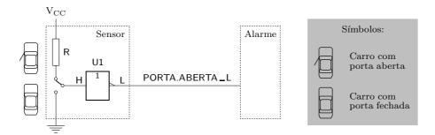
Figura 7.14: Sensor de alarme de um carro: quando a porta do condutor está aberta, na linha de saída do sensor aparece um nível L
