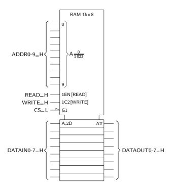
Figura 17.10: Símbolo IEC de uma RAM de 1<br/>k $\times$ 8 com dois barramentos de dados unidireccionais, um de entrada e um de saída, e saídas tri-state
