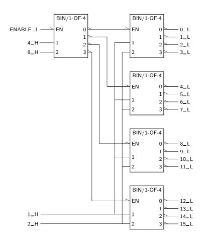
Figura 9.6: Logigrama com a estrutura de um descodificador binário de 4 bits com Enable, construído com descodificadores binários de 2 bits
