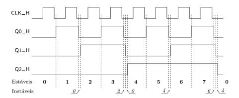
Figura 14.7: Repetição do diagrama temporal da Figura 14.6 que identifica os estados estáveis de contagem (a negrito) e os estados instáveis que ocorrem nalgumas transições (em itálico)
