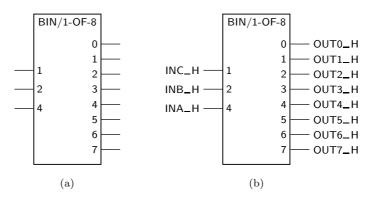
Figura 9.1: (a) Símbolo de um descodificador binário de 3 bits com todas as entradas e saídas activas a H, de acordo com a norma IEC 60617-12; (b) o mesmo descodificador com 3 variáveis booleanas simples aplicadas às entradas (com designações arbitrárias, sem conteúdo semântico), e possíveis designações para as funções booleanas simples de saída que são geradas pelo circuito
