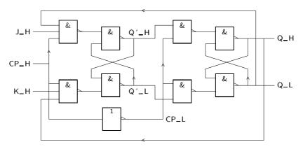
Figura 13.3: Logigrama de um flip-flop JK master-slave que comuta nos flancos descendentes
