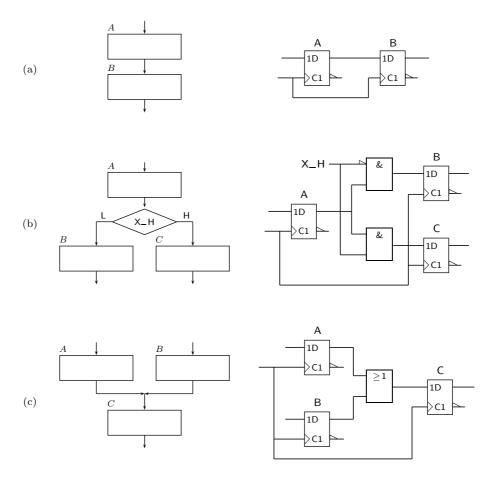
Figura 16.42: (a) Implementação, com um flip-flop por estado, de uma transição incondicional, (b) de uma transição condicionada ou "Fork", e (c) de uma convergência ou "Join" de um fluxograma
