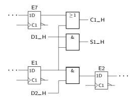
Figura 16.45: Implementação da transição do estado E1 para o estado E2 e das funções de saída  $C1\_H$  e  $S1\_H$  em função das variáveis de entrada  $D1\_H$  e  $D2\_H$  do circuito da Figura 16.37, usando um flip-flop por estado
