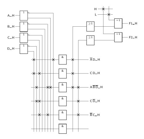
Figura 18.10: A PLA da Figura 18.5 permite implementar directamente a função F1 e, indirectamente, também a função F2 da Tabela 18.2
