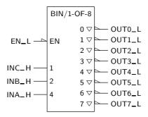
Figura 9.5: Símbolo IEC de um descodificador binário de 3 bits com entradas de dados activas a H e entrada de Enable activa a L, e com saídas "tri-state" activas a L. Ao símbolo adicionaram-se designações com conteúdo semântico para as entradas e saídas
