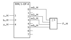
Figura 9.7: Implementação da função booleana simples  $F(a,b,c)=\sum m(0,2,3,5)$  que utiliza um descodificador binário de 3 bits e uma porta OR com entradas e saída activas a H
