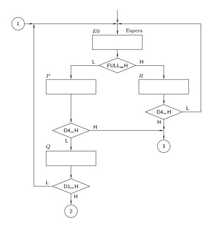
Figura 19.17: Parte inicial do fluxograma das Figuras 19.5 e 19.6, modificado para permitir um controlo por ROM com endereçamento explícito
