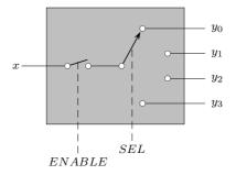
Figura 10.10: Analogia entre um comutador mecânico e a função de selecção de uma saída realizada por um demultiplexer
