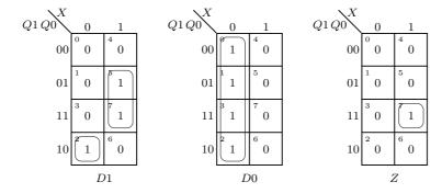
Figura 16.23: Quadros de Karnaugh para as excitações dos flip-flops D e para a saída do detector de sequências de Mealy da Figura 16.22
