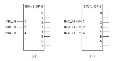
Figura 9.8: (a) Símbolo IEC de um descodificador binário de 3 bits com entradas activas a H; e (b) símbolo de um descodificador idêntico, mas com entradas activas a L
