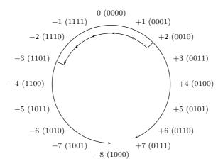
Figura 1.4: Representação gráfica da subtracção (+2)-(+5)=-3, com números de 4 bits representados em notação de complemento para 2
