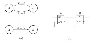
Figura 16.27: (a) Uma transição incondicional do estado A para o estado B no diagrama de estados (isto é, uma transição que não depende dos valores lógicos na entrada X), tem por correspondência (b) um troço do logigrama (com um flip-flop por estado) que se traduz pela ligação do flip-flop A ao flip-flop B
