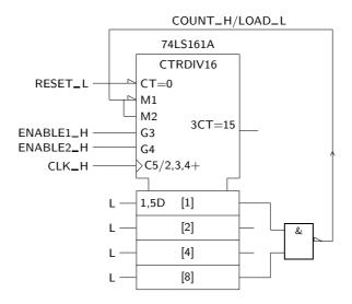
Figura 14.23: Contador síncrono de módulo 10 construído com base num contador do mesmo tipo mas de módulo 16
