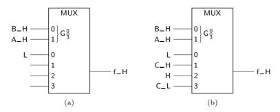
Figura 10.18: (a) Aplicação de um nível L à entrada 0 do multiplexer; (b) de uma maneira geral, temos de aplicar às entradas de dados as funções booleanas simples possíveis da variável booleana simples que sobeja, C, depois de escolhidas  $A \in B$  para aplicar às entradas de selecção
