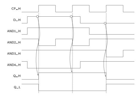
Figura 13.10: Diagrama temporal com o funcionamento do flip-flop D edge-triggered da Figura 13.9
