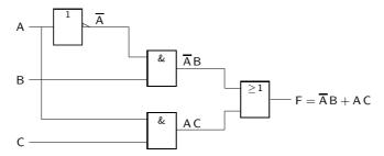
Figura 7.18: Logigrama da função  $F=\overline{A}\,B+A\,C$  que não leva em linha de conta os níveis de actividade nas entradas e na saída
