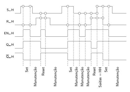
Figura 12.11: Diagrama temporal com o funcionamento de um latch SR controlado, onde se identificam os estados pelos quais o circuito passa
