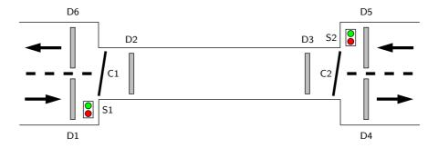
Figura 16.37: Uma estrada de montanha com duas cancelas, C1 e C2, seis sensores (detectores), D1 a D6, e dois semáforos, S1 e S2
