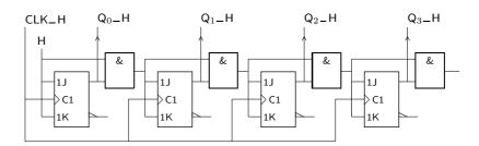
Figura 14.13: Um contador síncrono binário de módulo 16, que utiliza portas AND com 2 entradas para formar as equações lógicas dos  $J_i$  e  $K_i$  (excepto, naturalmente para  $J_0$  e  $K_0$ , que são ligadas a H). Note-se que a porta AND que gera  $J_1$  e  $K_1$  não era estritamente necessária, já que  $J_1 = K_1 = Q_0$ , mas foi incluída para realçar o padrão de formação dos  $J_i$  e dos  $K_i$
