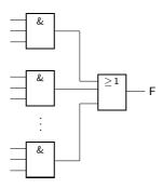
Figura 7.10: Logigrama (e esquema eléctrico simplificado) a utilizar quando se representa uma soma de produtos
