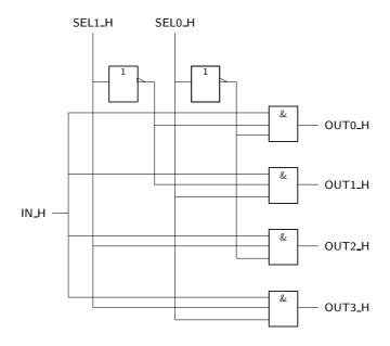
Figura 10.11: Logigrama de um demultiplexer com 4 saídas
