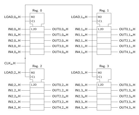
Figura 15.13: Quatro registos de 5 bits cada um, que pretendemos ver interligados  $\,$
