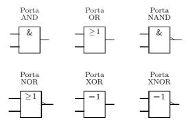
Figura 3.2: Símbolos IEC das portas AND, OR, NAND, NOR, XOR (que implementa a função OU-exclusivo) e XNOR (que implementa a função Equivalência) com 2 entradas
