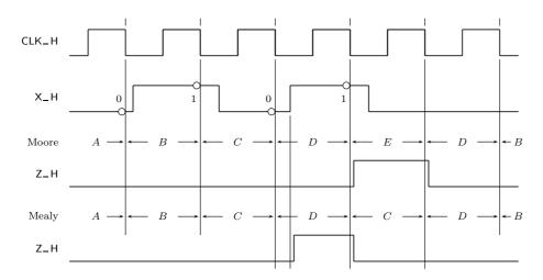
Figura 16.21: Diagramas temporais que ilustram a diferença de resultados obtidos na saída do detector da sequência 0101 se se optar por um modelo de Mealy ou por um modelo de Moore. Nesta figura detalha-se a Figura 16.9, por inclusão dos estados pelos quais as duas máquinas passam
