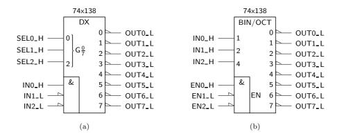
Figura 10.14: (a) Símbolo IEC do 74x138, utilizado como demultiplexer; e (b) símbolo do 74x138, utilizado como descodificador com Enable
