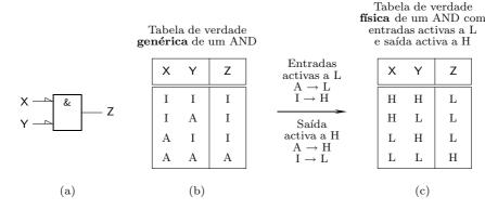
Figura 7.5: Porta AND com 2 entradas activas a L e saída activa a H; (a) símbolo IEC; (b) tabela de verdade genérica, válida para todos os ANDs com 2 entradas; e (c) tabela de verdade física para o AND da parte (a)
