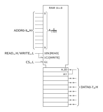
Figura 17.11: Símbolo IEC de uma RAM de 1<br/>k $\times$ 8 com um único barramento de dados, bidireccional, e com saídas tri-state
