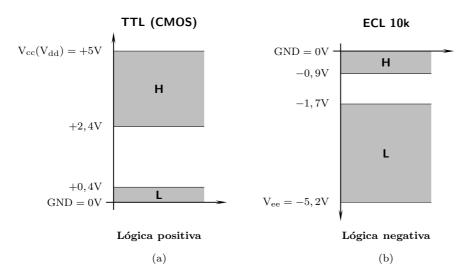
Figura 7.1: (a) A utilização de uma tecnologia TTL (ou CMOS) favorece a escolha de uma lógica positiva, enquanto que (b) a utilização de uma tecnologia ECL favorece a utilização de uma lógica negativa
