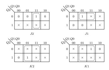
Figura 14.17: Quadros de Karnaugh de onde se podem extrair as equações de excitação dos flip-flops do contador síncrono de módulo 6
