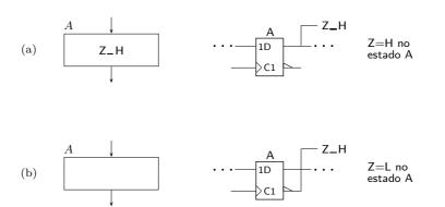
Figura 16.43: Implementação de uma saída de Moore de um fluxograma, com um flip-flop por estado
