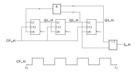
Figura 13.15: Exemplo de circuito sequencial síncrono
