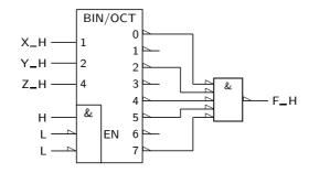
Figura 9.11: Logigrama de um circuito que implementa uma função booleana simples cuja expressão se pretende determinar
