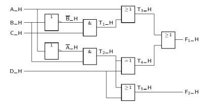
Figura 8.2: Logigrama de um circuito combinatório onde se identificam as funções  $T_1$  a  $T_5$  nas saídas das portas lógicas que interessa analisar para a obtenção das equações de saída do circuito
