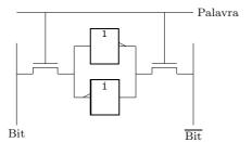
Figura 17.12: Estrutura de uma celula de memória estática em tecnologia MOS, com um total de 6 transistores
