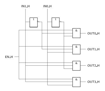
Figura 10.12: Logigrama de um descodificador binário de 2 bits com Enable, que acentua a semelhança com o demultiplexer com 4 saídas da Figura 10.11
