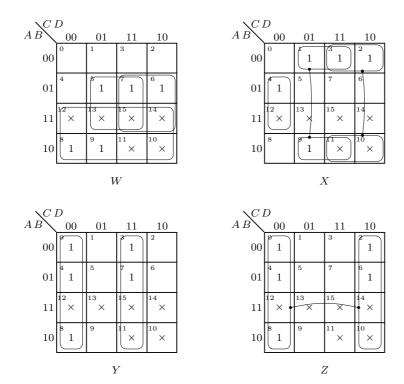
Figura 8.10: Minimização das funções de saída do conversor BCD  $\rightarrow D+3$
